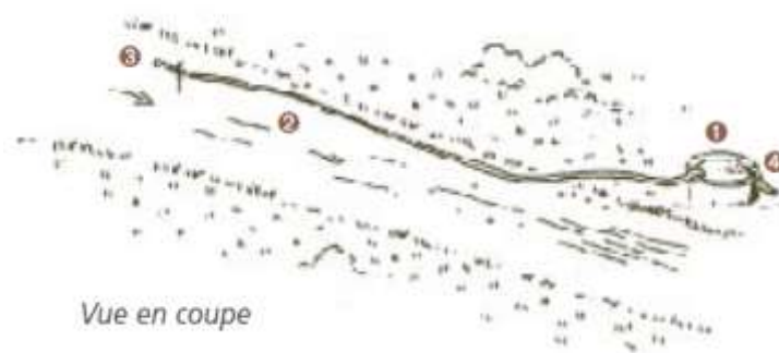
Schéma de principe d'un abreuvoir gravitaire (CATER Basse-Normandie, 2001).
